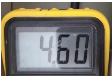
Slika 7. Izmerena vrednost napona na kondenzatoru pri napajanju od 12 V
