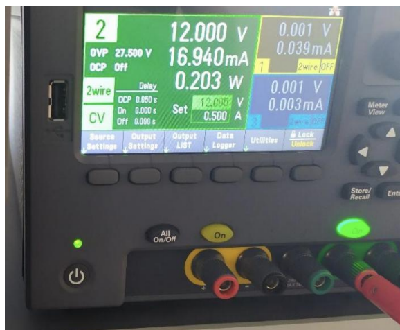
Slika 8. Izmerena strujna potrošnja IoT uređaja pri naponu napajanja od 12 V
