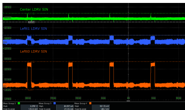
Slika 5. Oscilogram SIN signala izmerenih sa centralnog, osmog i dvanaestog po redu drajvera u komunikaciji
