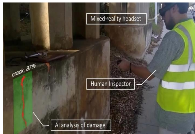
Слика 3. Примена вештачке интелигенције приликом инспекције објекта [11]
