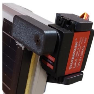
Слика 4. Серво мотор на конструкцији
