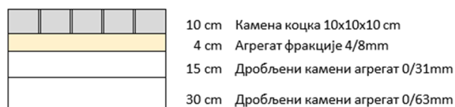
Slika 1. Приказ слојева за поплочавање каменом коцком
