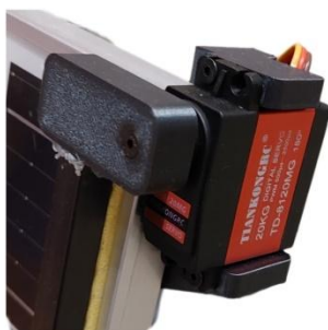
Слика 4. Серво мотор на конструкцији
