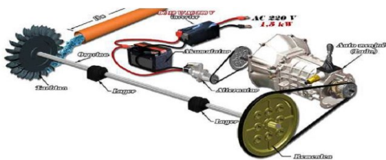
Slika 3. Dijelovi i povezivanje u sistem hidroelektrane [5]
