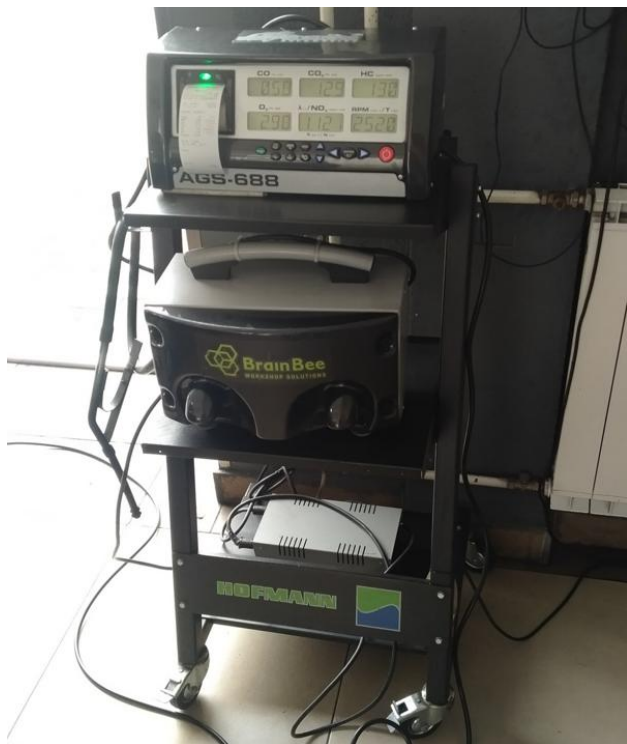
Slika 1. Univerzalni gasni analizator BRAIN BEE, tip AG5-688
