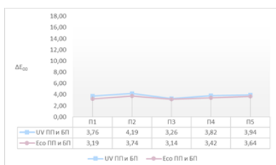
Slika 16. Ukupna razlika u boji \Delta E_{00} tonova plavih boja između različitih podloga na istoj mašini
