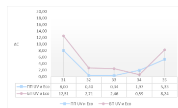
Slika 7. Razlika u zasićenju tonova zelenih boja između različitih mašina na istoj podlozi
