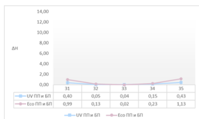
Slika 10. Razlika u tonu reprodukovanih tonova zelenih boja između različitih podloga na istoj mašini
