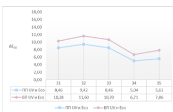
Slika 15. Ukupna razlika u boji \Delta E_{00} tonova zelenih boja između različitih mašina na istoj podlozi
