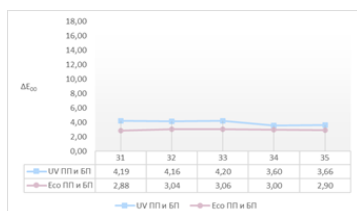
Slika 14. Ukupna razlika u boji \Delta E_{00} tonova zelenih boja između različitih podloga na istoj mašini
