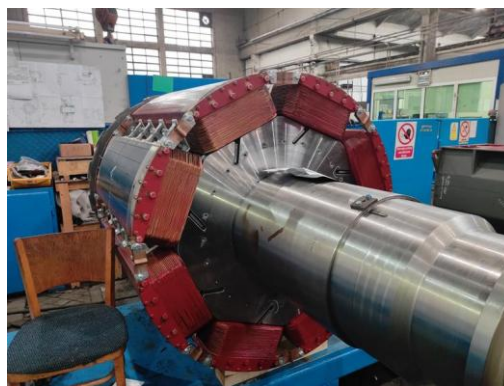
Слика 1. Ротор хидрогенератора
