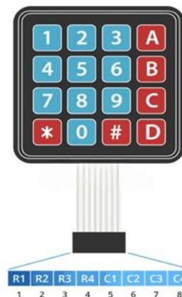
Slika 5. Izgled 4x4 tastature u raspored pinova [4]
