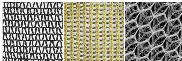
Слика 5. Пример различитих врста расел мрежа од полимера [11]
