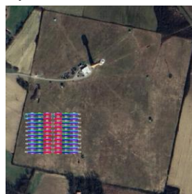
Slika 3. Dispozicija FN elektrane sa fiksnom konstrukcijom [6]
