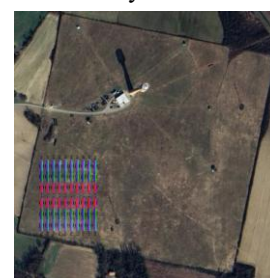
Slika 5. Dispozicija FN elektrane sa automatizovanim sistemom
