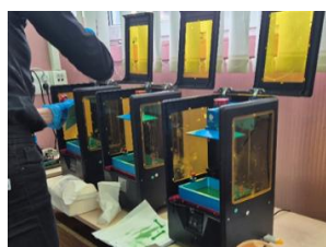
Слика 2. Завршетак штампања и уклањање модела
