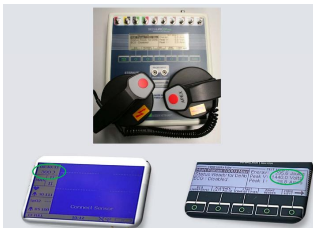
Слика 1. Начин постављања лопатица дефибрилатора током тестирања [горе]; Екран дефибрилатора након испоруке енергије [доле лијево]; Екран тестера након извршеног теста [доле десно] [9]
