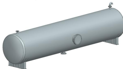
Слика 2. Модел посуде под притиском
