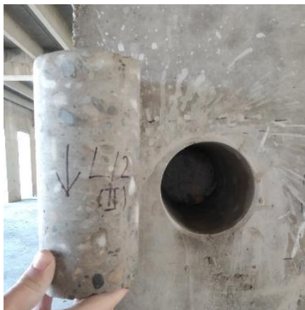
Слика 12. Преглед и обележавање извађеног бетонског језгра
