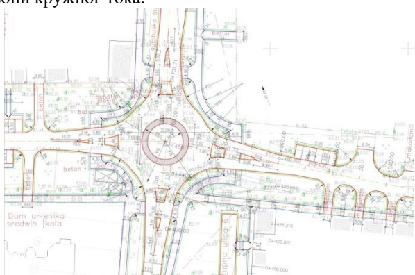
Слика 9. Ситуационо решење постојеће кружне раскрснице
