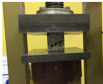
Slika 4. Ispitivanje čvrstoće betona na pritisak
