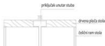
Ilustracija 2. Detalj instalacija unutar stola
