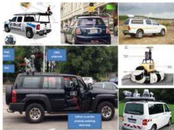
Слика 3. Мобилни ласерски системи за скенирање са аутомобила
