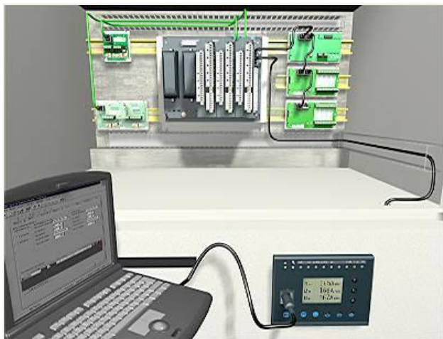
Slika 3.3. Parametrisanje zaštitnog releja
