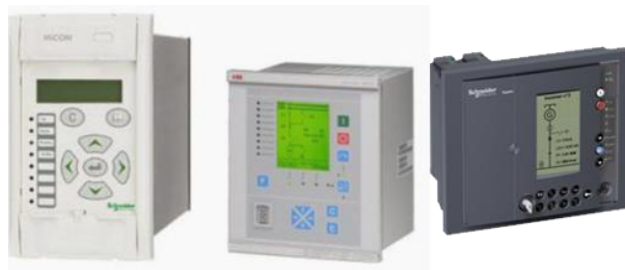
Slika 2.1. Izgled današnjih mikroprocesorskih zaštita različitih proizvođača
