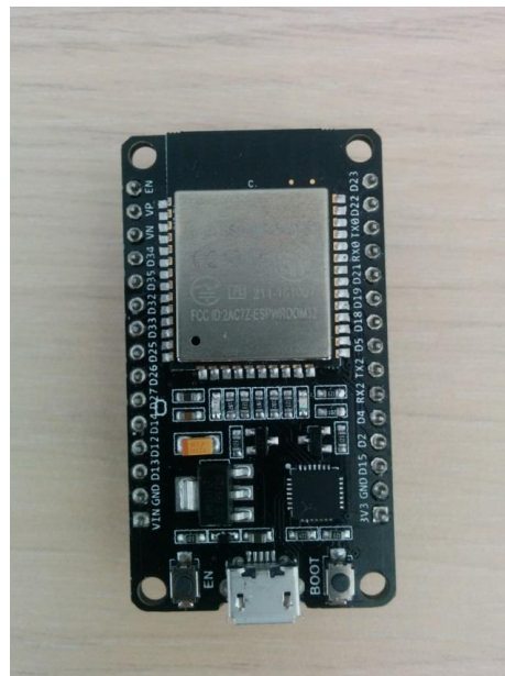
Слика 1: Изглед ESP DevKit v1 развојне плоче
