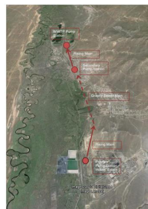
Слика 1. Графички приказ снабдевања WWTP отпадним водама
