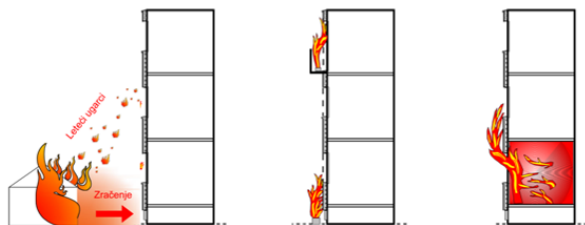
Slika 1. Scenario razvoja požara na fasadi zgrade [7, 8]
