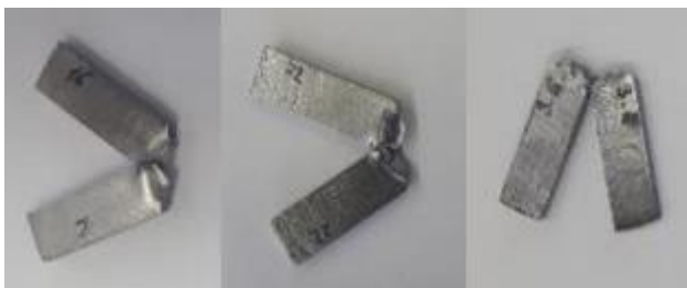
Слика 5. Узорци након испитивања на Шарпију
