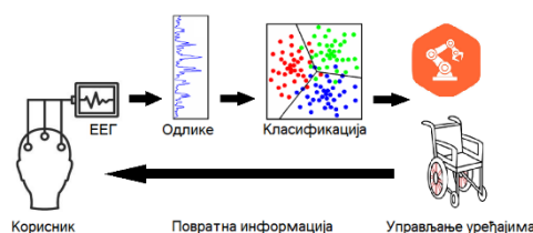
Слика 1. Уопштена архитектура BCI система за управљање уређајима попут роботске руке или моторизованих инвалидских колица.
