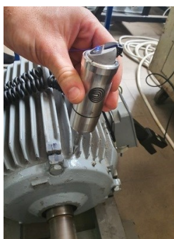
Slika 3. Bežični troaksijalni akcelerometar u radu
