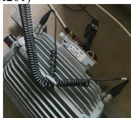
Slika 4. Kablovski jednoaksijalni akcelerometar
