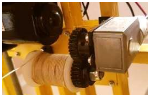
Slika 12. Pogonski mehanizam dizanja na kolicima
