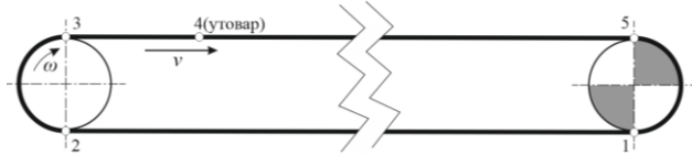
Слика 4. Карактеристичне тачке на транспортеру
