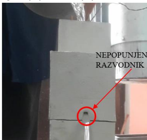
Slika 8. Isticanje rastopa iz ravnog povišenog razvodnika
