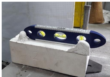
Slika 3. Dovođenje podeone ravni u horizontalni položaj
