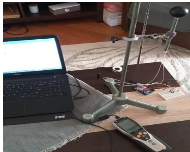
Slika 5 Merni štand za određivanje MRT
