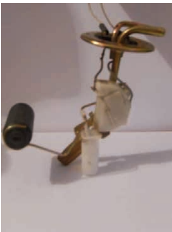
Slika 4. Polužni davač goriva sa amortizerom [3]
