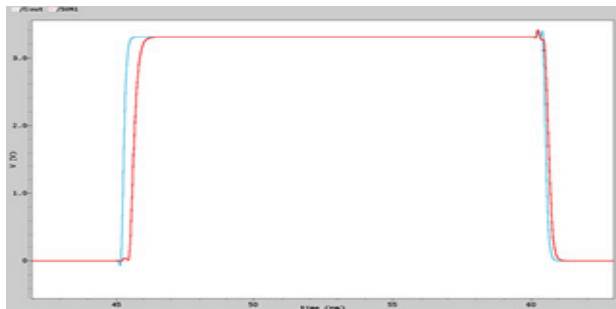
Slika 6. Vremenski dijagram izlaznih signala SUM1 i Cout kada se menja bit prenosa kod dvobitnog CMOS sabirača
