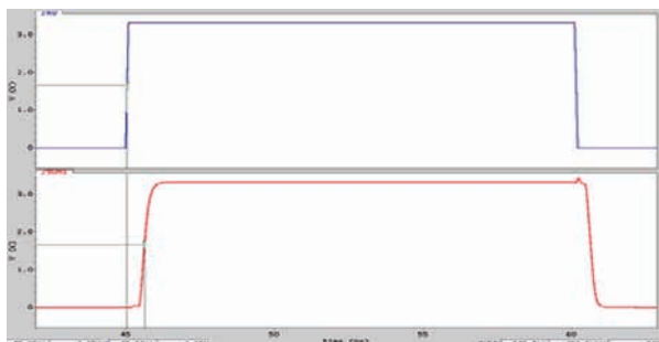
Slika 8. Merenje vremena propagacije t_{PLH} izlaznog signala SUM1 dvobitnog CMOS sabirača
