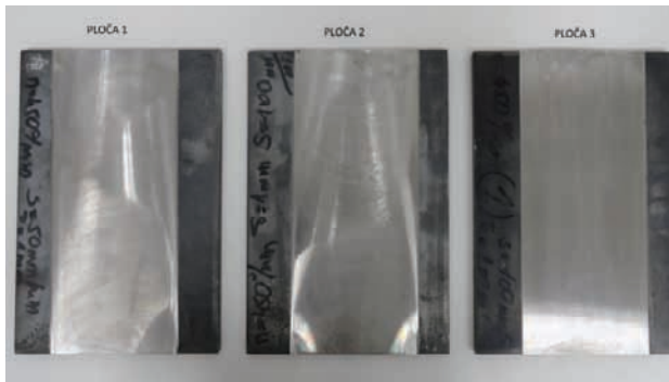
Slika 3. Radne ploče čija se ravnost ispituje
