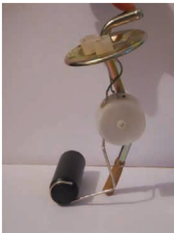
Slika 3. Polužni davač goriva bez amortizera [3]
