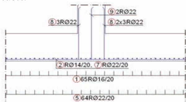
Slika 3.2. Detalj armiranja donje zone temeljne ploče sa ankerima za stub
