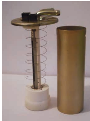
Slika 5. Cevni davač goriva sa štampanim potencijometrom [3]
