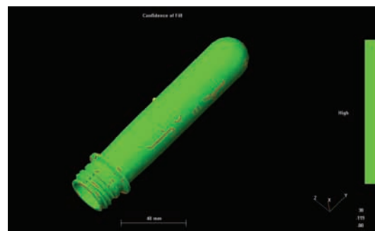
Slika 5: Nepovoljna pojava linija zavarivanja usled postavljanja ulivnog sistema na bok predforme
