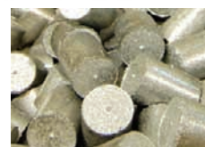
Slika 5.2: Presa za briketiranje metalne strugotine i izgled metalnog briketa
