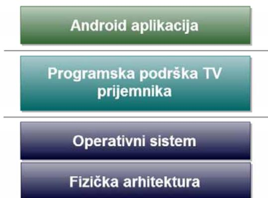
Sl. 2. Struktura programske podrške Android baziranog prijemnika digitalnog TV signala.
