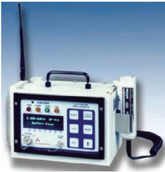
Slika 5. Dozimetar sa GM (Gajger-Milerovim) brojačem
