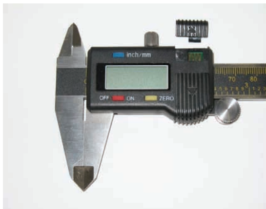
Slika 2. Izlazni pinovi digitalnog pomičnog merila
