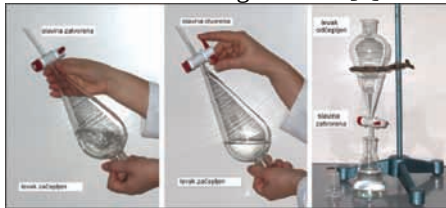
Slika 1. Postupak rada sa levkom za ekstrakciju [3]
