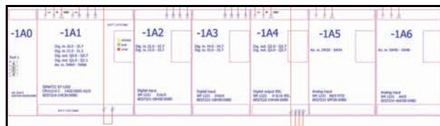
Slika 9. Strujna šema PLC-a na mHE Mokra Gora
