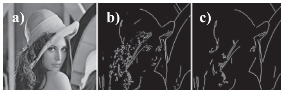
Sl. 2 - Među-koraci u procesu unapređenja detekcije ivica; Originalna slika (a), slika nakon primene Sobel operatora (b), slika nakon izbora regija od interesa (c)
