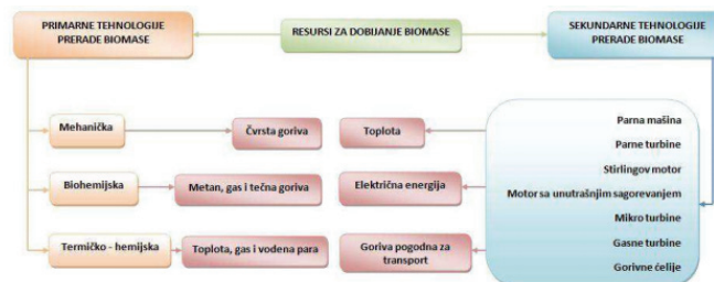
Slika 1: Primarne i sekundarne tehnologije prerade biomase [5]
