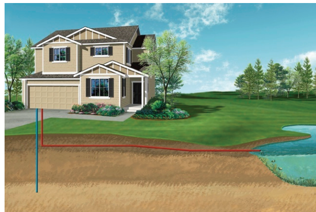
Slika 3.1.1. Geotermalni sistem sa otvorenom petljom
