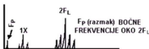
Sl.4. Spektar za ekscentričnog rotora
