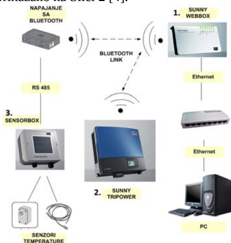
Slika 2. Blok šema komunikacije u elektrani
