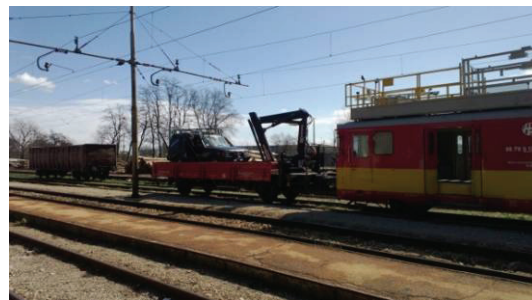
slika 3. Vozilo postavljeno na vozilo na željeznici sa MTLS om.
