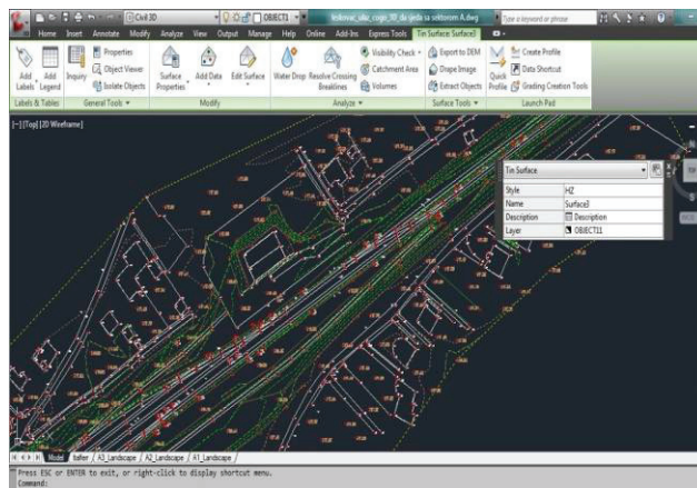
slika 7. TIN surface ili model površina
