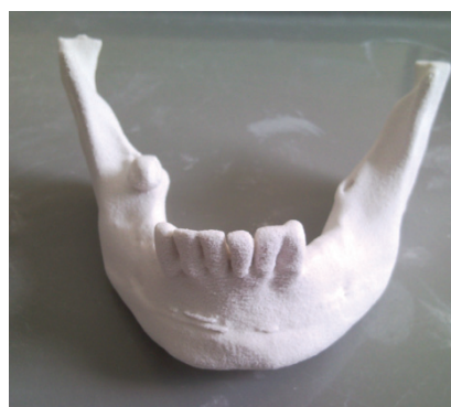
Slika 6. Završni model dobijen 3D štampe
