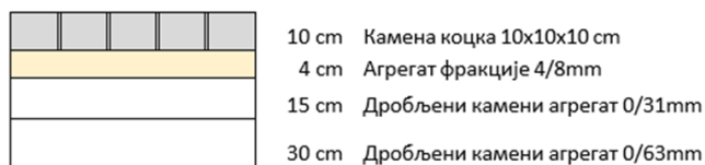
Slika 1. Приказ слојева за поплочавање каменом коцком
