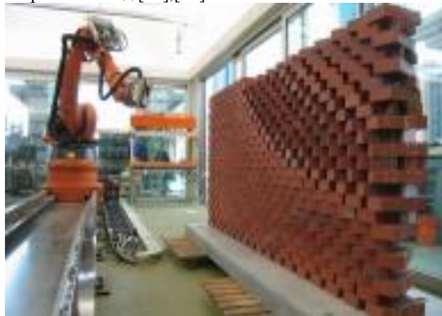
Слика 4. Зидања помоћу робота [13]
