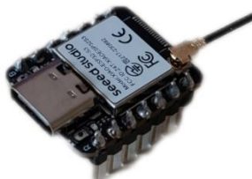
Слика 2. Микроконтролер XIAO ESP32S3
