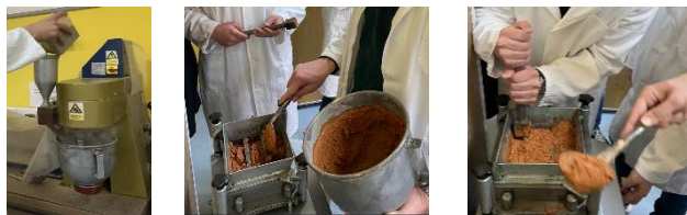
Слика 4. Поступак справљања малтера
