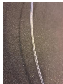
Слика 1. Мултимодно пластично оптичко влакно са зарезима пречника 2 mm
