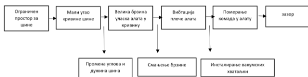
Слика 8. Redosled događaja – uticaj dizajna konstrukcije transportnih šina
