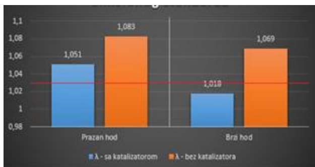
Slika 4. Vrijednost lambda kod vozila EURO 3 emisionog standard sa i bez katalizatora
