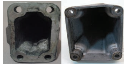
Slika 14. Analizirani nosač motora (levo) i nosač motora E-Klase tipa W211 (desno)
