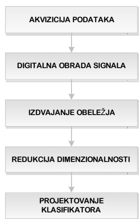
Slika 1 Algoritam za analizu stanja mehaničkih elemenata indukcionih motora
