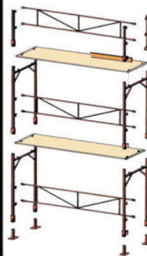
Slika 3: Tipski delovi skele
