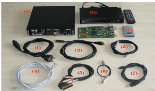
Sl. 2: Uređaji i kablovi koji se koriste u testiranju: (a) NAVIC, (b) STB uređaj, (c) DekTec kartica, (d) RC emulator, (1) kabl za napajanje, (2) HDMI kabl, (3) RF kabl, (4) LAN kabl, (5) SCART kabl, (6) SPDIF kabl, (7) USB mini kabl
