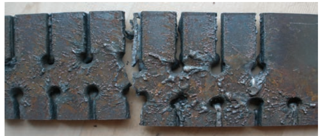
Slika 9. Primeri rezova na sivom livu, za različite brzine rezanja
