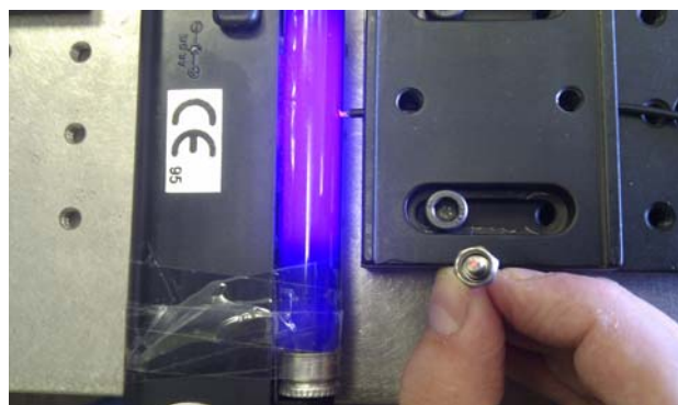
Slika 4. Merenje zavisnosti intenziteta emitovanog fluorescentnog zračenja merenog senzorom sa prahom iz živine lampe od udaljenosti ovog senzora od UV lampe
