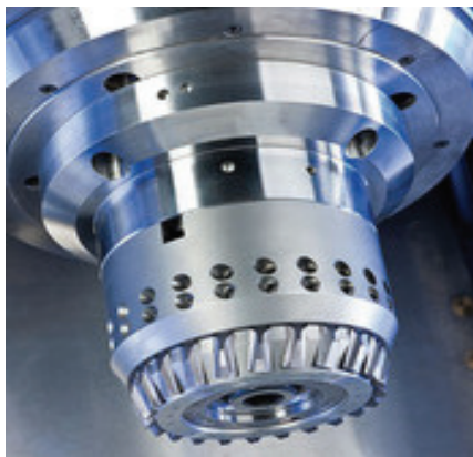
Slika 4: Novi alat za izradu unutrašnjeg ozubljenja firme Klingelberg [2]
