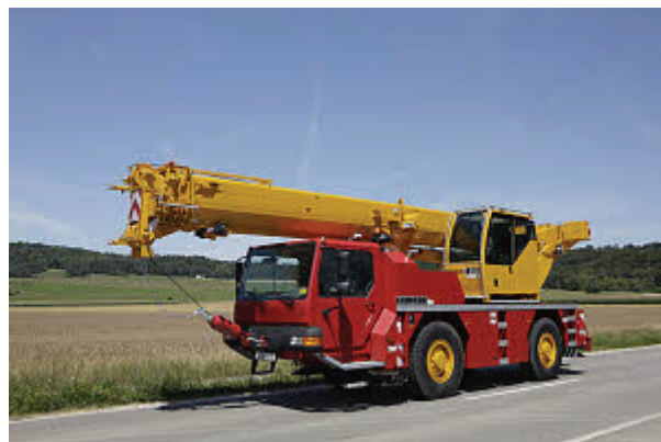
Slika 3. Samohodna dizalica LTM 1040-2.1
