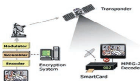
Slika 4. Put prenosa skremblovanog signala
