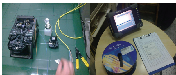
Slika 5 Splajsovanje i merenje OTDR-om
