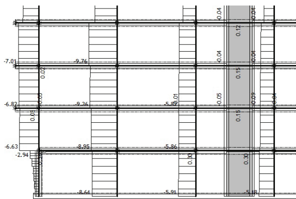
Slika 3: Deo rama u osi B, normalni naponi u stubu
