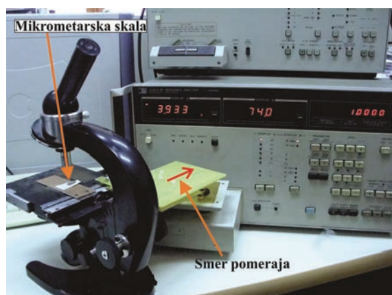
Slika 4. Izgled aparature za merenje karakteristika LC senzora.
