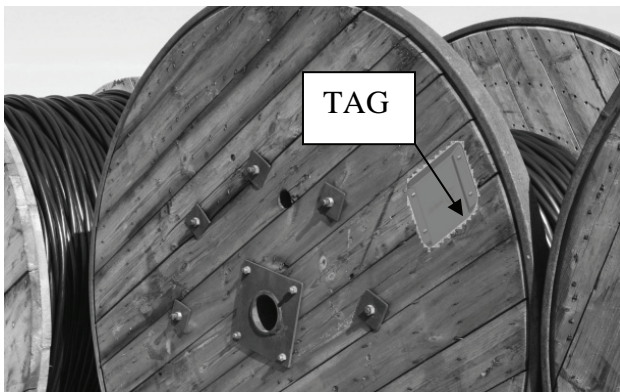
Slika 3. Kotur kabla opremljen tagom za višestruku izmenu podataka
