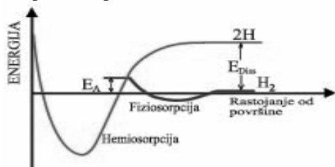
Slika 3. Vrste adsorpcije zavisno od energije [3]
