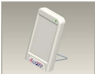
Slika 6. Izgled RFID čitača firme Summit Automation [3]
