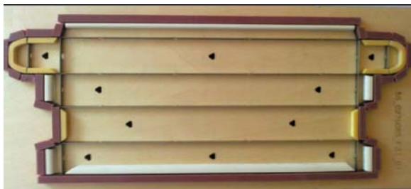
Slika 7.: Prikaz realnog izgleda štanc forme
