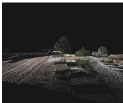
Slika 2. 3D prikaz podataka dobijenih laserskim skeniranjem iz vazduha
