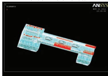
Slika 9. Položaj sila na postolju pri obradi na sredini raspona šiljaka
