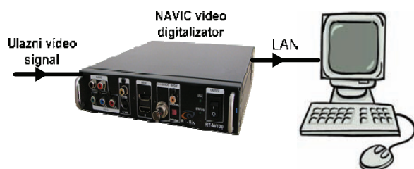
Slika 2. Principijska šema zasnovana na NAVIC greberu i LAN vezi između računara i grebera
