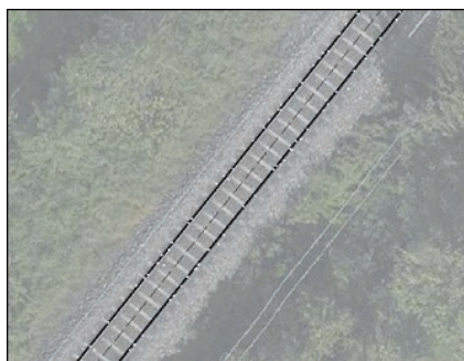
Slika 4. Izdvojeni kolosek: šine (puna), železnička srednja linija (isprekidana) i filtrirane železničke tačke (bela)
