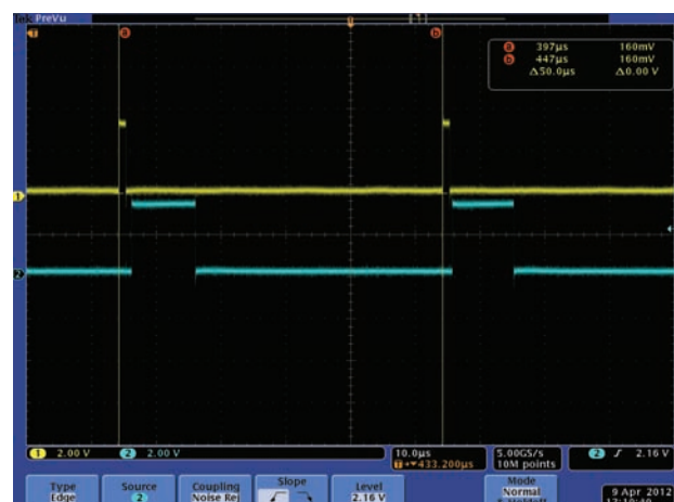
Sl.5.Vremenski dijagram instrukcija unutar PWM interval
