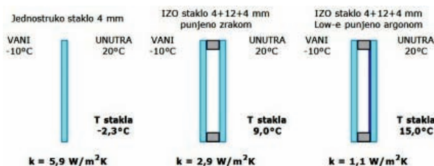
Слика 2. Вредност k -коэф. зависно од дебљине и врсте стакла.
