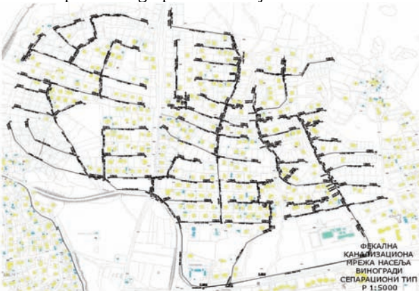
Slika 3. –dispozicija fekalne kanalizacione mreže separacionog tipa
