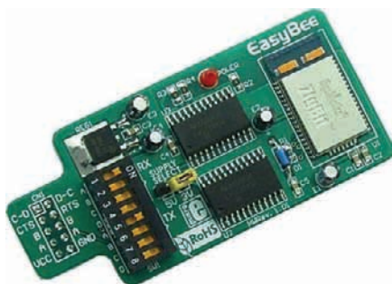
Slika 2. Izgled EasyBee komunikacionog modula.
