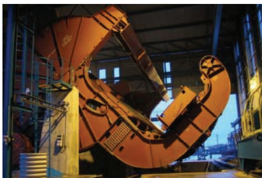
Slika 5. Uređaj za istovar rasutog materijala iz vagona na bočnu stranu
