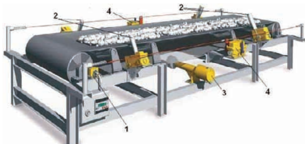
Slika 8. Trakasti transporter sa pojedinim mernim i sigurnosnim komponentama, 1-temperaturni senzor ili davač brzine obrtanja bubnja, 2-senzor podešenosti trake, 3-davač brzine trake, 4- sigurnosni uređaj sa užetom
