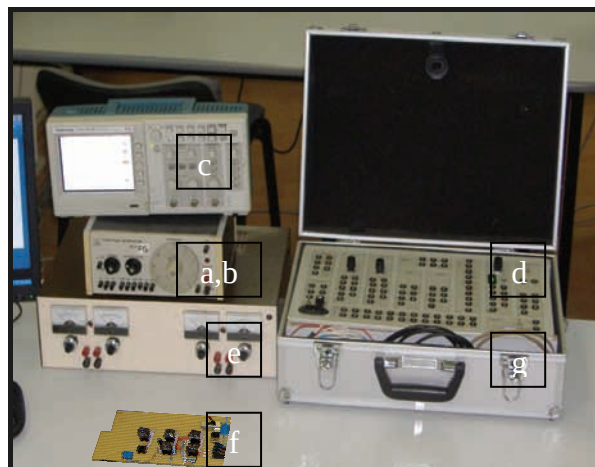
Slika 1. Prva verzija uređaja korišćenog prilikom ispitivanja jednog EKG pojačavača.
