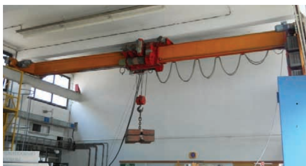
Slika 7. Kretanje dizalice sa teretom mase 1000 kg - kolica na sredini raspona
