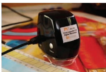
Slika 2. Sibress PIT kontrolni merni mikroskop
