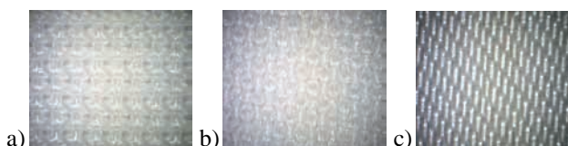
Slika 3. Korišćeni tekstilni materijali snimljeni Sibress PIT kontrolnim mernim mikroskopom: a) Eco Flag 117, b) Creasefree Canvas 200 i c) Silk satin 110
