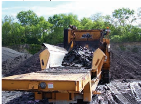
Slika 2. Reciklirani ostaci - Reciklirani komadi čiste se i direktno odvoze na novu trasu.
