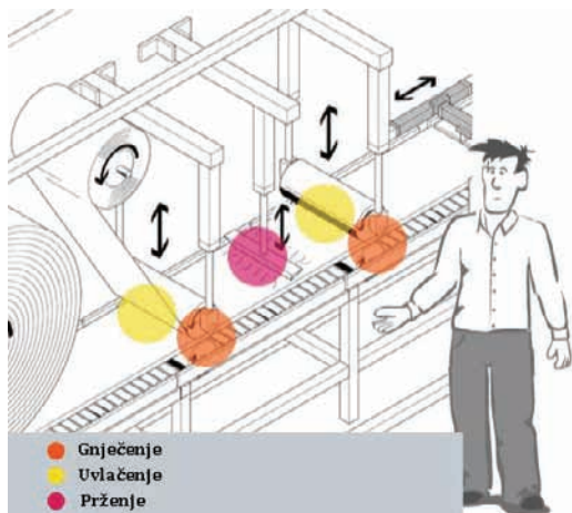
Slika 2. Modul za lamiranje
