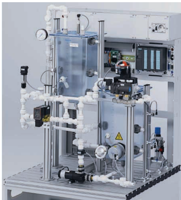
Slika 3.1 MPS®PA procesna stanica
