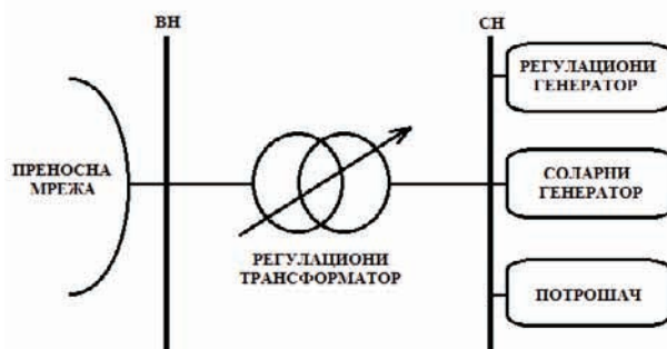
Слика 2.1 – Принципска шема електроенергетског система
