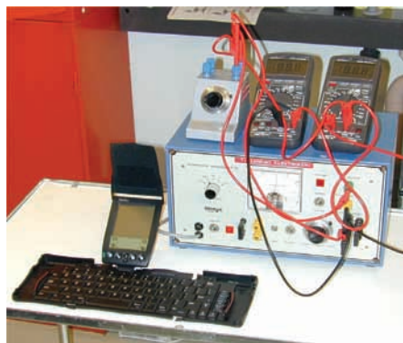
Slika 3. Oprema korišćena za EChT. U pozadini se vidi potencijostat. U prvom planu Palm pilot IIIx spojen je sa prenosnom tastaturom
