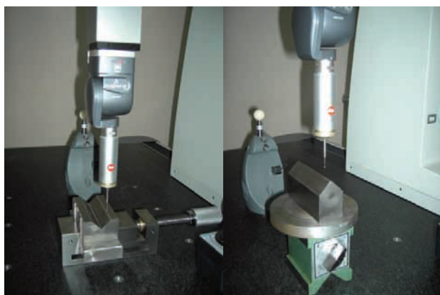
Slika 4. Merenje dimenzija alata
