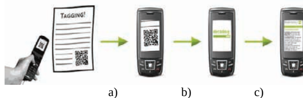
Slika 1. Mobilno tagovanje a) očitavanje 2D bar koda pomoću mobilnog telefona b) dekodiranje c) otvaranje web stranice na internetu
