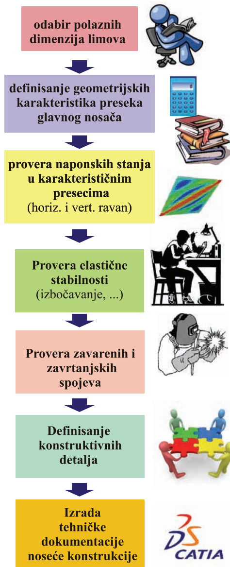
Slika 5. Tok projektovanja glavnog nosača
