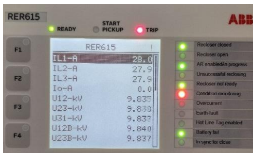
Слика 5. Приказ мјерења на управљачкој јединици током симулације у реалном времену
