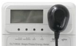
Slika 4. Optički port na DLMS brojilu
