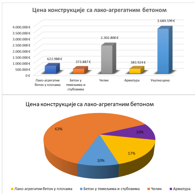
Слика 16. и 17. приказ удела свих материјала у укупној цени спрегнуте конструкције са лако-агрегатним бетоном [7]
