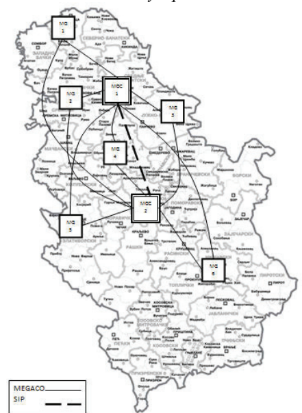
Слика 2. Пример двоструке повезаности MG-а и MGC-а у мрежи
