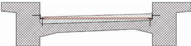
Слика 10. Ојачавање коловозне плоче са горње стране
