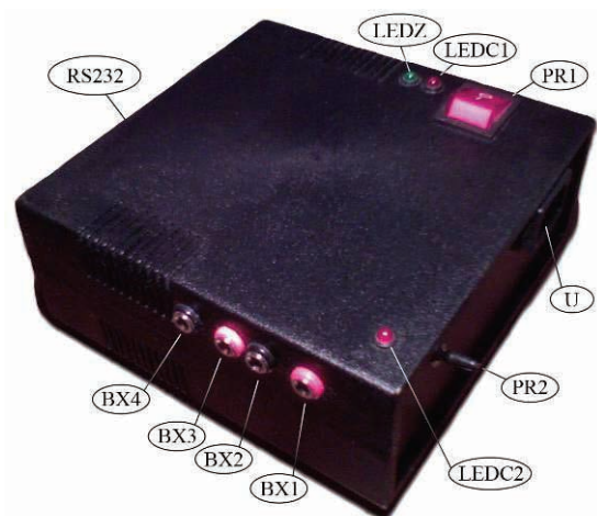
Slika 9. Izgled uređaja sa označenim konektorima, prekidačima i svetlećim indikatorima
