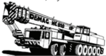
Slika 5.2.: Demag (nosivosti 330t)
