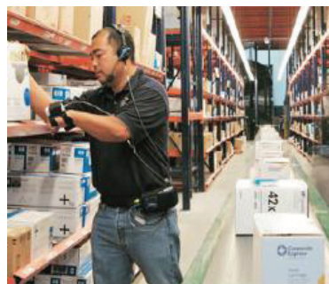
Слика 2. Комисионирање које омогућава и бар код скенирање и pick to voice технологију
