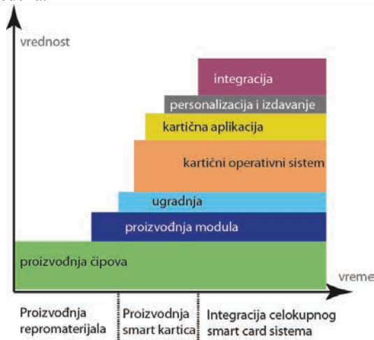
Slika 1. Lanac proizvodnje u smart card tehnologiji
