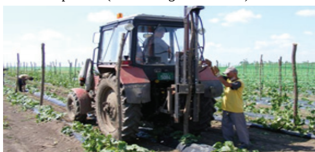
Slika 6. Hidraulični traktorski uređaj za postavljanje stubova
