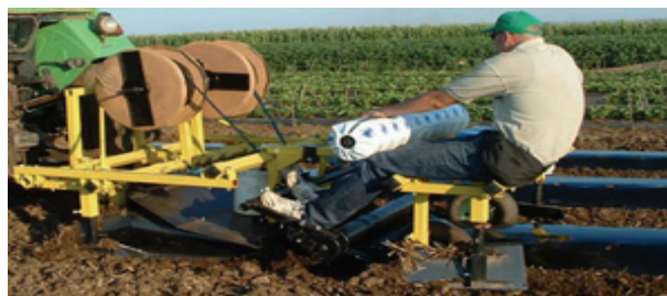
Slika 3. Traktorska priključna mašina za postavljanje folije i kapajućih traka uz istovremenu izradu bankova
