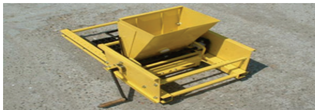
Slika 1. Uređaj za punjenje kontejnera supstratom
