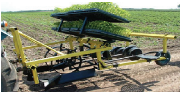
Slika 4. Traktorska priključna mašina za rasađivanje povrća
