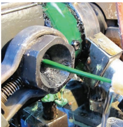
Sl 10: Stabilizacija sekundarne zaštite optičkog vlakna pod uticajem temperature
