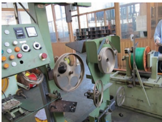
Sl 11: Kontrolisanje prečnika optikog vlakna i namotavanje na kotur
