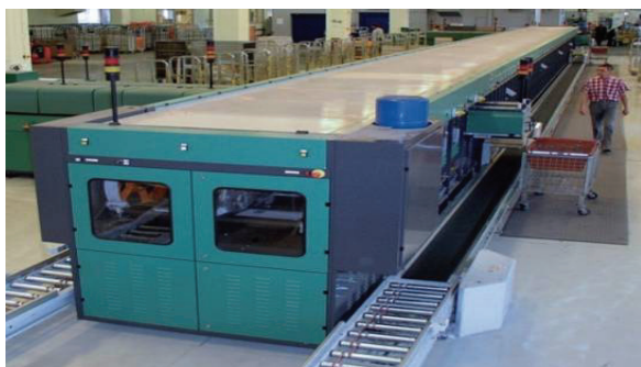
Slika 3. Kompaktna mašina za preradu pismonosnih pošiljaka produženog formata
