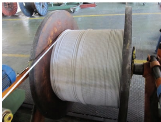
Sl 14: Stabilizacija i učvršćivanje spoljašnjeg zaštitnog omotača i dobijanje krajnjeg proizvoda – optički kabl
