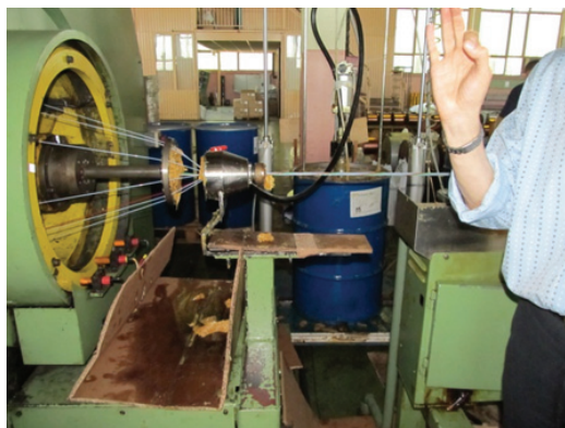
Sl 12: Formiranje optičkog kabela – pletenje izolacije sa optičkim vlaknima
