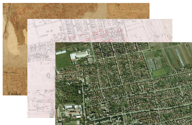
Slika 5. Integrisani, precizno urazmereni i georeferencirani ortofoto snimci sa modifikovanim katastarskim podacima - planovi razmere 2880 prevedeni u razmeru 1:2500, omogućuju digitalizaciju nedostajućih podataka
