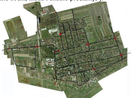
Slika 4. Kontrolni profili snimani GPS – om, metodom kontinualne kinematike u realnom vremenu sa intervalom registracije od 1s. ▲ - Kontrolna tačka
