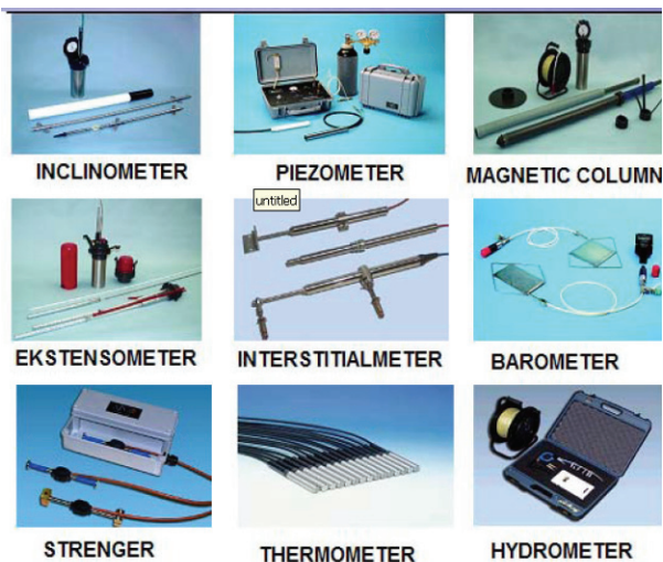
Slika 2. Instrumenti za fizičke metode određivanja deformacija
